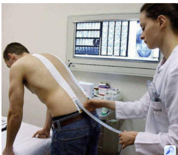
In der Berliner Charité führt eine Ärztin den Messstreifen mit den Dehnungssensoren in die am Rücken befestigten Führungsbahnen ein. Foto: Epionics
